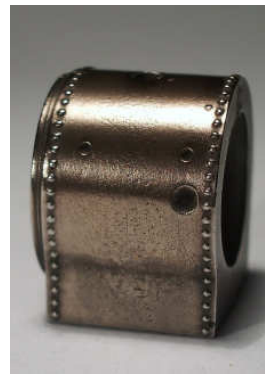
Foto 9 Het eindresultaat. De onregelmatigheden die u op het oppervlak ziet zijn simpelweg eigen aan witmetaal gietwerk
