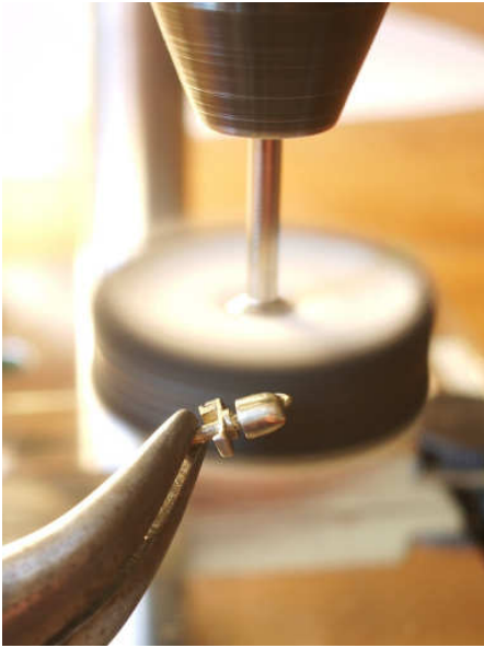
Foto 6 Het echte werk: polijsten. Let nu helemaal op dat uw werkstuk niet wegvliegt. De schijf draait met 5000 toeren per minuut, daar komt zo'n bel een heel eind mee!!
