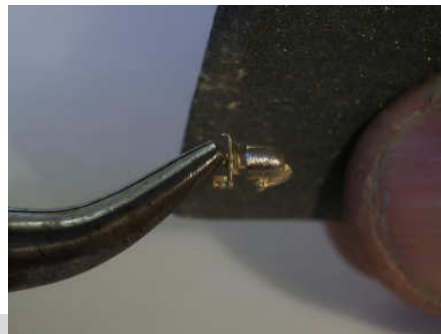
Foto 5 Schuren met korrel 230 schuurpapier. Niet alleen de gietnaad maar de hele bel moet geschuurd worden. Een priegelwerkje. Wanneer u de bel aan de gietboom laat zitten is hij beter hanteerbaar, maar ik had deze bel al van de gietboom afgehaald. Een tangetje biedt dan uitkomst maar pas op dat hij er niet tussen uit schiet, want anders kunt u het eerstkomende kwartier mopperend op uw knieën door de huiskamer kruipen.
